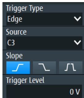
Figure 2-2: Edge trigger
